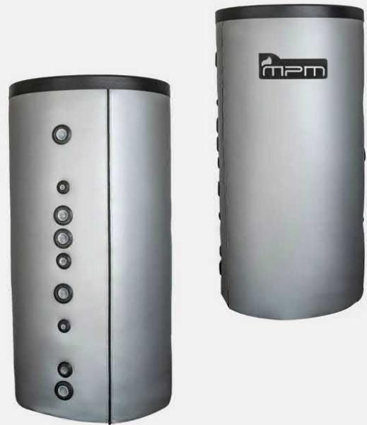
Der Pufferspeicher erhält Warmwasser aufrecht, das durch verschiedene Heizgeräte erzeugt wurde und zur Versorgung der Zentralheizung verwendet wird. Der Speicher ohne Wärmetauscher lässt die Einschalthäufigkeit des Kessels bzw. der Wärmepumpe begrenzen und ermöglicht die Wassertemperatur in der Heizanlage auf stabilem Niveau zu sichern. Er erfüllt gleichzeitig Funktion einer s.g Kupplung und schützt die Anlage vor dem Überhitzen.
